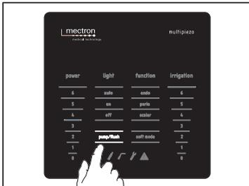
3 Starten Sie den Reinigungsmodus, indem Sie PUMP/FLUSH auf dem Bedienfeld wählen: Alle anderen vorhanden Auswahlmöglichkeiten werden deaktiviert;
