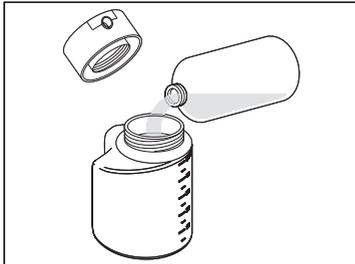
1 Füllen Sie den Flüssigkeitsbehälter mit Wasser oder wie empfohlen demineralisiertem Wasser. Schliessen Sie den Behälter an das Gerät an;
