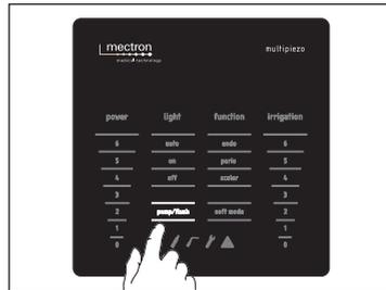
Während die Schrift PUMP/FLUSH blinkt, drücken Sie ein Mal den Fußanlasser und lassen ihn wieder los. PUMP/FLUSH blinkt nicht mehr und der Flüssigkeitskreislauf beginnt sich zu füllen;
